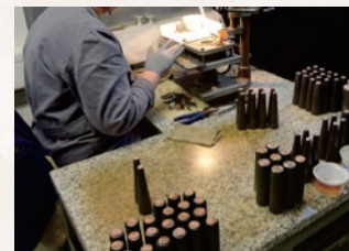
銅板を一枚ずつ工具に固定していく作業
